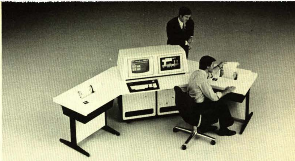
Dispositif central de réglage automatique du chauffage et de la climatisation dans de grands ensembles de bureaux.
