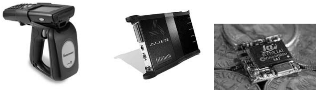
Figure 3. Lecteurs RFID Lecteur de type pistolet (à gauche), lecteur de type ordinateur (au centre) et lecteur miniature (12 x 12 x 2 mm) (à droite)
