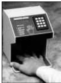
Figure 5. Scanner de la géométrie de la main
