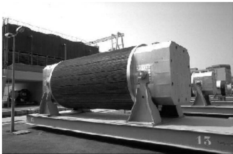
Figure 11.1 – Colis de type B représentatif (Source COGEMA, France)
