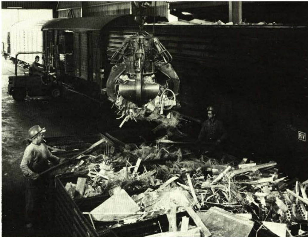
Le recyclage de l'aluminium exige beaucoup moins d'énergie que la production d'aluminium de première fusion. L'aluminium secondaire ainsi obtenu représente déjà 20 % de la production totale du métal.
