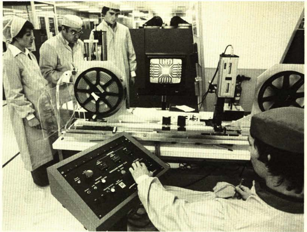
Fabrication de microprocesseurs à l'usine Honeywell Bull d'Angers (France) : les tolérances sont vérifiées à l'aide d'un microscope électronique. Ces techniciens font-ils partie d'un secteur « quaternaire » ?
