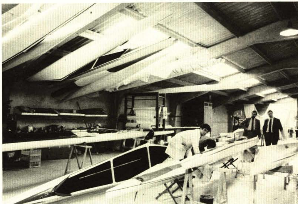
Des activités classiques peuvent être revitalisées grâce à de nouveaux matériaux ou à de nouveaux procédés, qui se combinent pour former ensemble un « système technique ». Ci-dessus : utilisation de fibres composites (carbone) et de colles nouvelles (époxy) pour construire des canoës de compétition. Ci-dessous : utilisation de rayons X et d'ordinateurs pour « sonder » des métaux.
