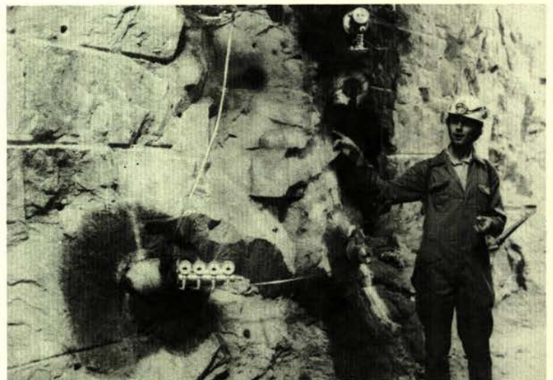
Un projet international (États-Unis, Suède) en cours de réalisation à la mine de Stripa (Suède). Les photos montrent une expérience in situ simulant les effets de chaleur dégagée par des déchets de haute activité dans des formations de roches cristallines.
