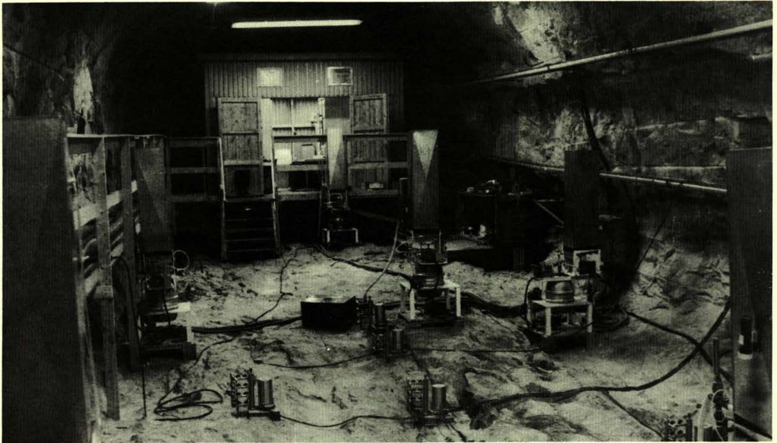
Un projet international (États-Unis, Suède) en cours de réalisation à la mine de Stripa (Suède). Les photos montrent une expérience in situ simulant les effets de chaleur dégagée par des déchets de haute activité dans des formations de roches cristallines.
